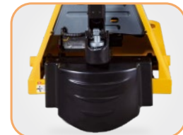
Захисна кришка Захист приводного двигуна, Анти-топкання
